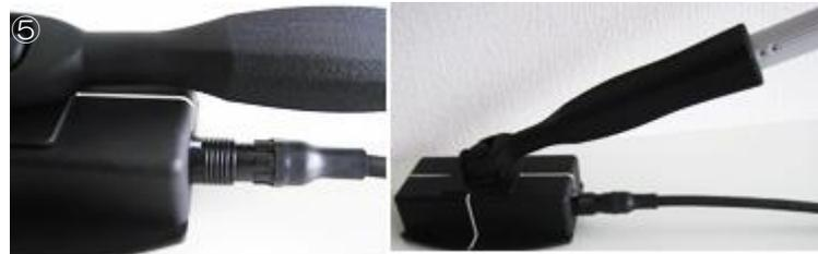
⑤プローブ信号コネクタへ信号ケーブルコネクタを合わせて「カチッ」と入るまで押し込みます(本体側の接続も同様に行ってください)
