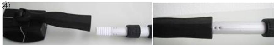
④プローブアダプタと延長棒の取り付け(延長棒を右回して取り付けます)
