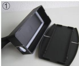
①プローブアダプタを開き,プローブをセットします
