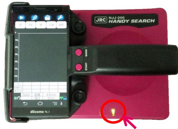
スマートフォンとセンサー本体の接続が確立すると、センサー本体のLEDが緑色点灯します。
