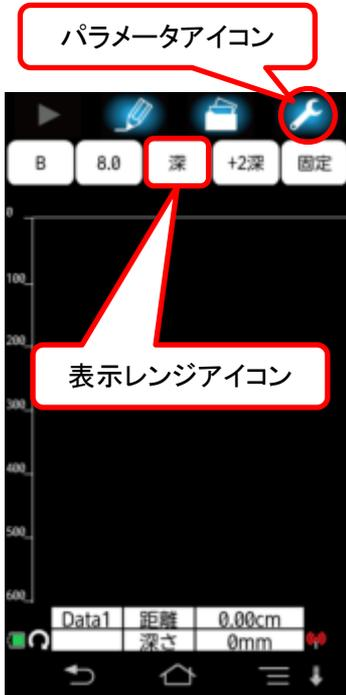
※表示レンジ設定はBモード画面上で“ピンチイン”、“ピンチアウト”操作することで変更することもできます。
