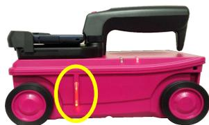
センサー本体左右側面のLEDが探査開始・探査終了位置
