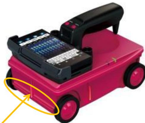
※“前面チョークガイド”中央LEDの真下へ正確に墨出しします。
