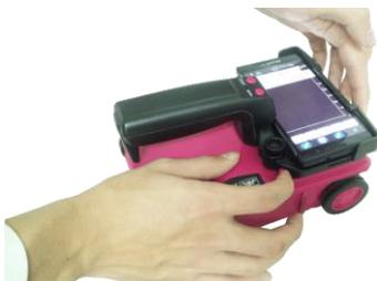
② 固定レバーを解除した状態でスマートフォンを固定させます。
