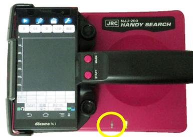
電源スイッチをONにすると、LEDが点滅してバッテリー残量がわかります。
