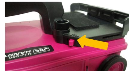
④ 取り外す際は固定レバーを矢印方向に押しスマートフォンを取り外して下さい。
