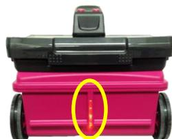
センサー正面LEDと後面LED位置を走査線上に合わせて走査します。
