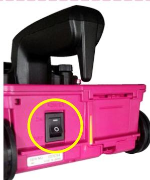
バッテリー装着後、電源スイッチをONにします。
