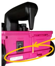
※“後面チョークガイド”中央LEDの真下へ正確に墨出しします。
