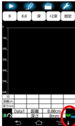
⑥接続が確立するとアンテナマークが“緑色”になります。右側にセンサー本体のバッテリー残量も表示されます
