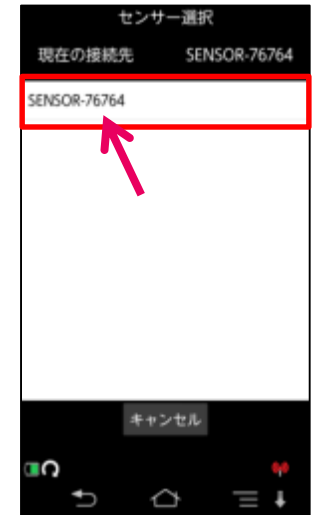
④センサーを選択して、押します。 探査画面に移行します。※セン サー本体が複数ある場合は接続 先のリストに複数表示されます。
