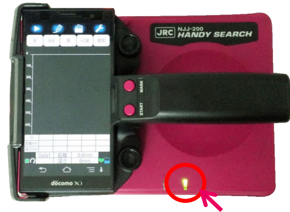
④センサーを選択して、押します。 探査画面に移行します。※セン サー本体が複数ある場合は接続 先のリストに複数表示されます。
