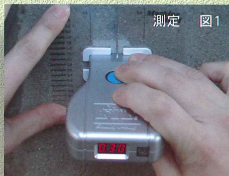
2.次にMarking Sheetの白い枠に合せてCrack EYEをセットし、Crack EYEのボタンを押します。CrackEYEに測定結果が表示されます。
